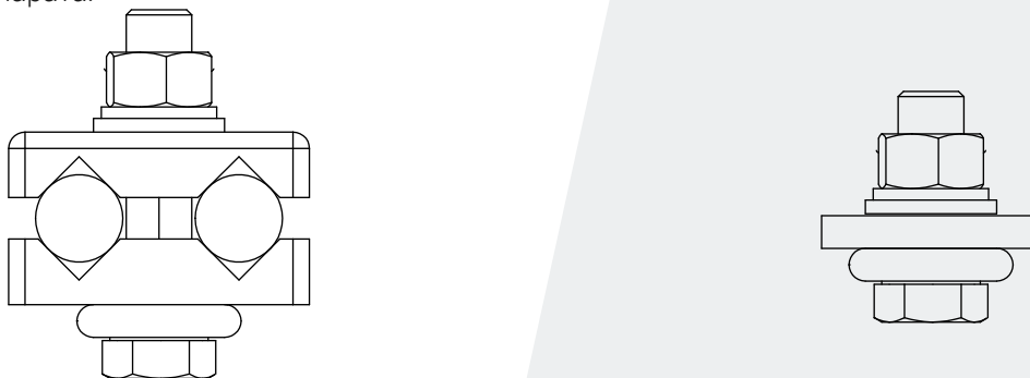
Рис. 21 Способ подключения ошиновки из прутьев с накладками и стандартных шин
