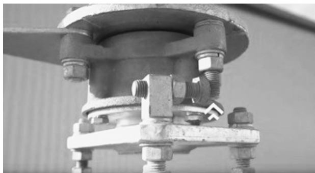
Рис. 19. Правильное размещение стопорного болта
