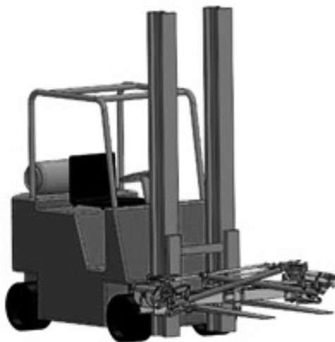
Рис. 8. Способ подъёма основания разъединителя
